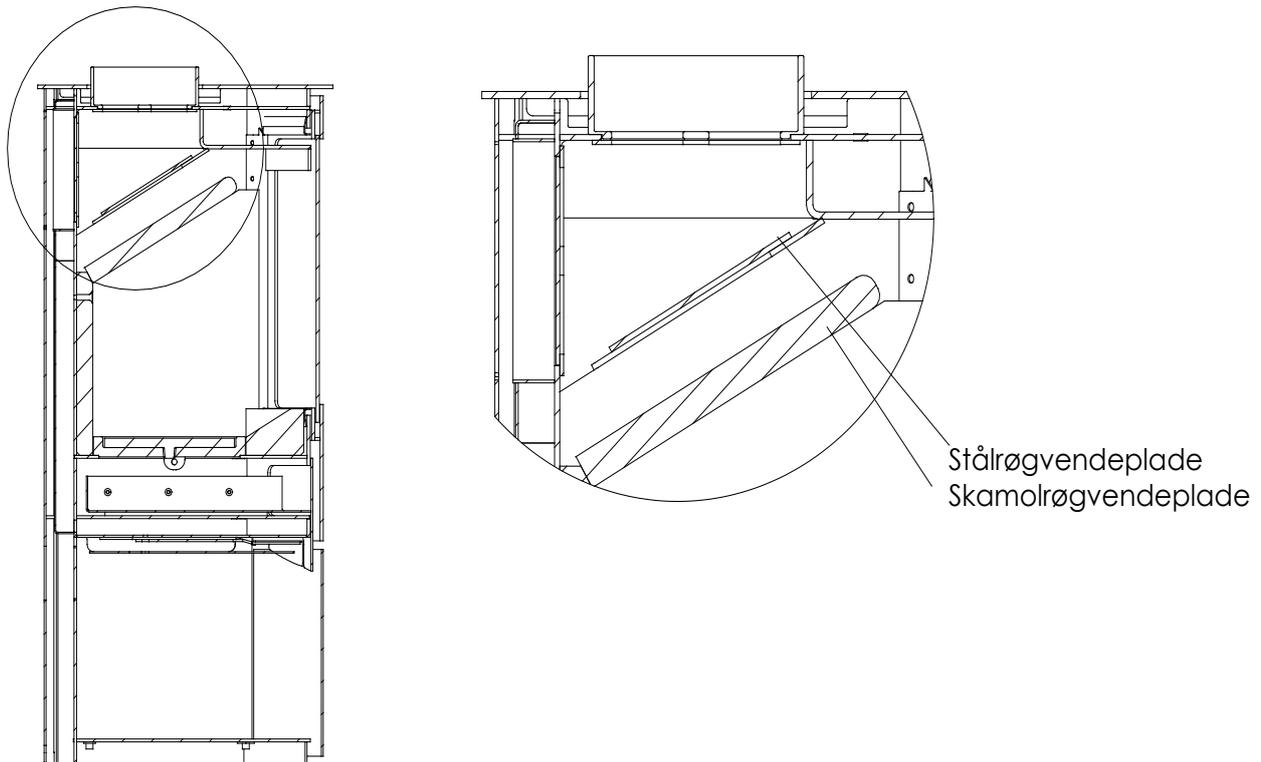
Les plaques d'orientation de la fumée sont retirées chacune à la fois. Chaque plaque d'orientation de la fumée est retirée en étant soulevée d'un côté, après quoi elle peut être libérée de l'autre côté et descendue dans la chambre de combustion puis sortie par la porte. Elles sont également mises en place en les plaçant de travers sur l'un des côtés puis sur l'autre côté puis mises à leur place au milieu.
