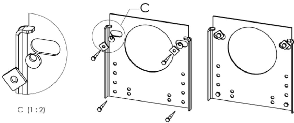
Installer ensuite le poêle sur la ferrure. Le poêle comporte deux trous qui s'adaptent aux deux trous supérieurs de la ferrure. Fixer le poêle sur la ferrure à cet endroit.
