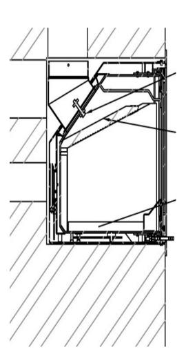
Pour retirer le déflecteur de fumée, soulevez-le d'un côté et il se libère de l'autre, vous pouvez alors le sortir par la porte en le passant par le foyer. De la même manière, pour le mettre en place, on l'introduit en le penchant d'un côté, puis de l'autre, avant de le stabiliser et de le pousser au fond du poêle.
