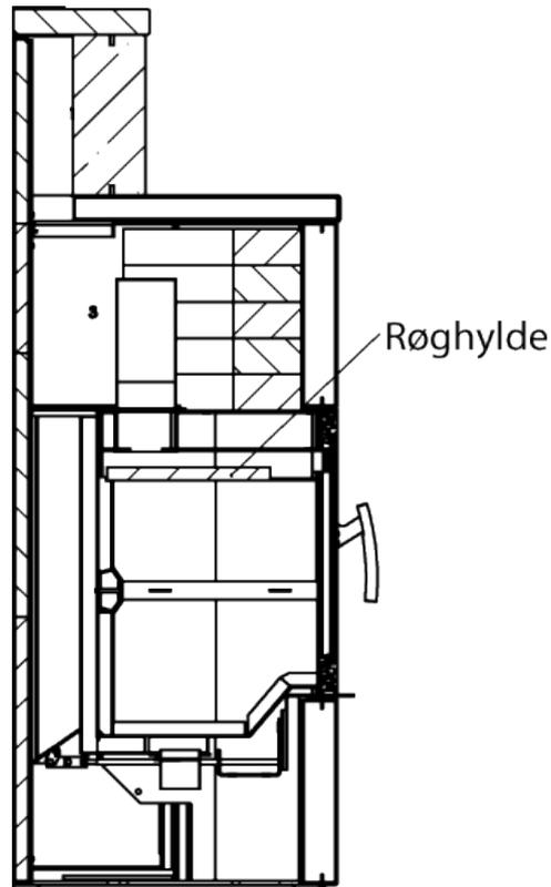
Cette plaque se retire en la soulevant par un côté, après quoi elle est libérée sur l'autre côté et on la récupère par le bas de la chambre de combustion et à travers la porte. De la même manière en sens inverse, on réintroduit la plaque en la glissant de travers d'un côté d'abord, puis de l'autre, pour parvenir à la remettre en place et la pousser bien en arrière.
