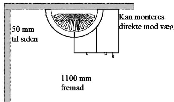
Important : Il faut, en outre, ménager de la place sur les côtés pour que le nettoyage puisse s'effectuer sur le côté du poêle.
