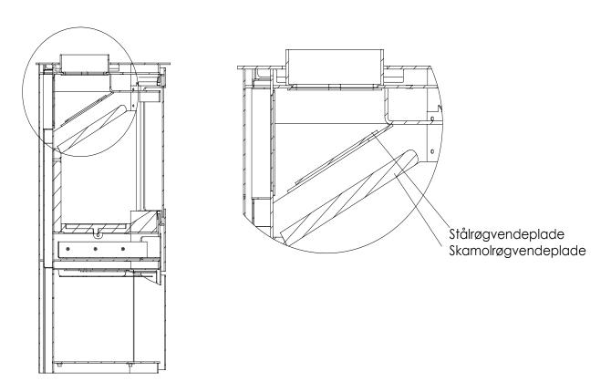
Les plaques d'orientation de la fumée sont retirées chacune à la fois. Chaque plaque d'orientation de la fumée est retirée en étant soulevée d'un côté, après quoi elle peut être libérée de l'autre côté et descendue dans la chambre de combustion puis sortie par la porte. Elles sont également mises en place en les plaçant de travers sur l'un des côtés puis sur l'autre côté puis mises à leur place au milieu.
