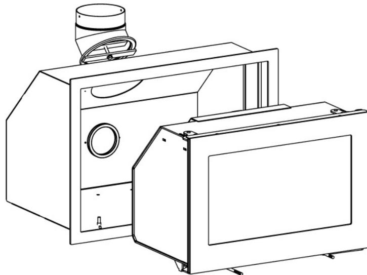
Die Kassette ist aus den Haken bei den vorderen Füßen auszurasten und aus dem Gehäuse herauszunehmen. Das Knierohr ist an den Schornstein anzuschliessen.
