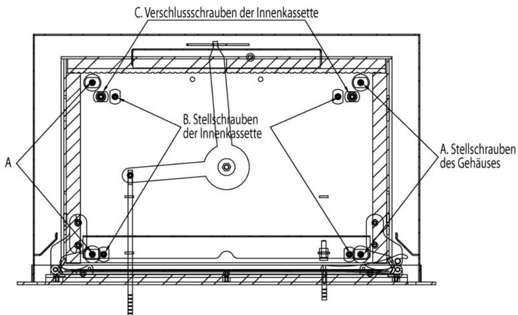
A:Löcher für die Befestigung der Einsatz im Verhältnis zur Unterlage.
