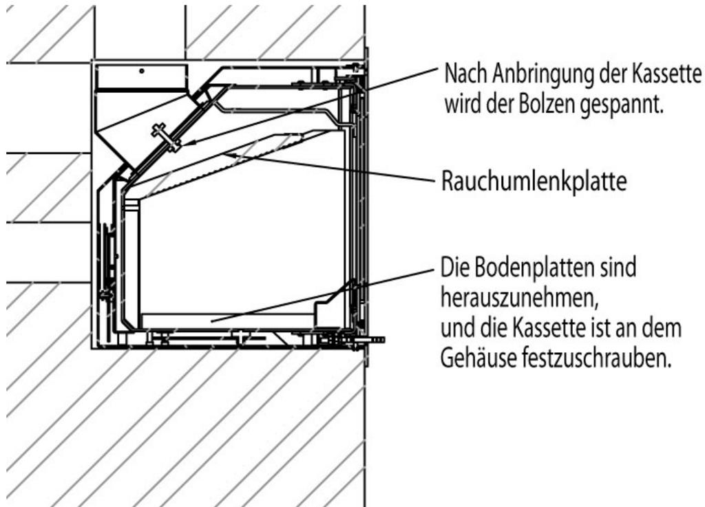
Es gibt unzähligen Möglichkeiten die Kassetten einzubauen. Die können in der Wand und auf der Wand gebaut werden, und sie können an der Wand hängen. Bloss darf Einbauen nur in Verbindung mit unbrennbarem Material stattfinden. Fast alle Installationen werden individuell entworfen und in allem Fallen soll der Abstand zum Brennbaren in Übereinstimmung mit den Vorschriften sein.
